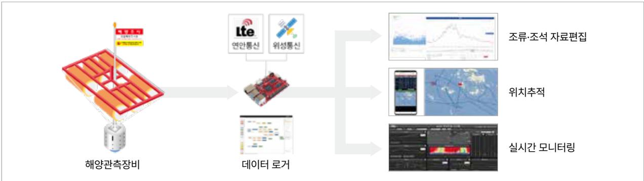
실시간 데이터 전송 및 모니터링 시스템
